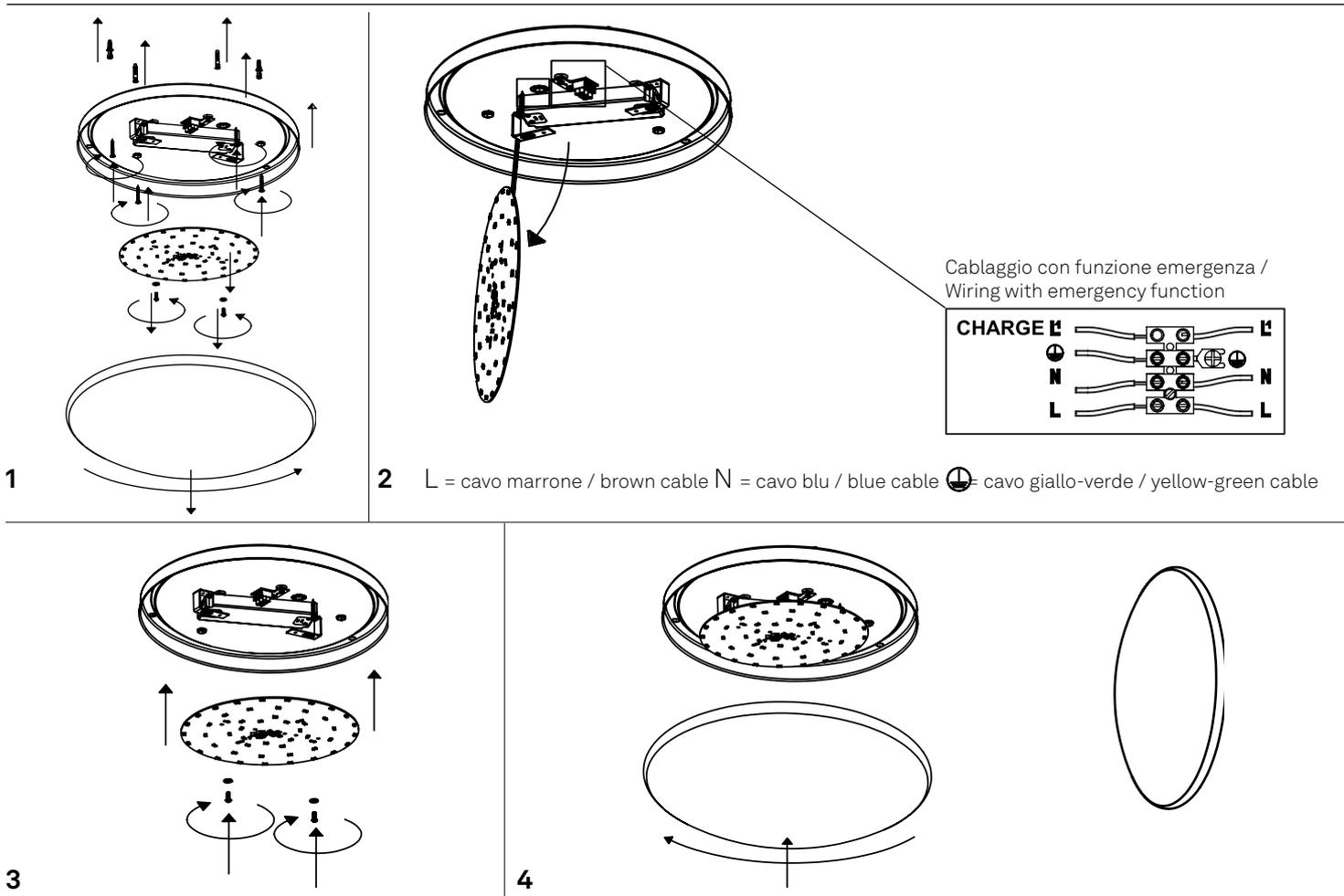
1) L'apparecchio non comprende un dispositivo di prova, sarà cura dell'installatore provvedere secondo la norma vigente;
