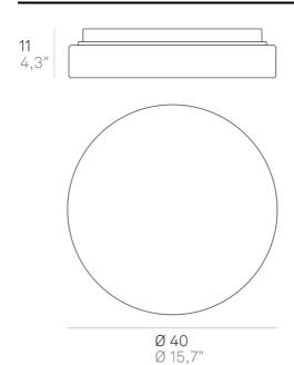
LED sostituibile da utente dimmable IP20
