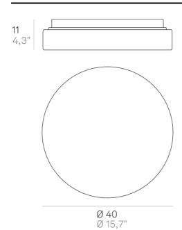
LED sostituibile da utente not dimmable IP20
