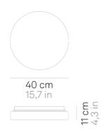
LED sostituibile da utente not dimmable IP44
