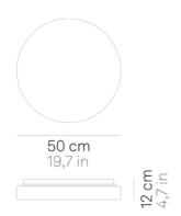
LED sostituibile da utente not dimmable IP44
