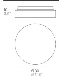
LED sostituibile da utente dimmable IP20
